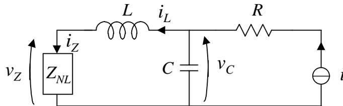
Scrivere le equazioni di stato del sistema, scegliendo come variabile di stato  $x = [i_L, v_C]^T$  e come variabile di ingresso  $u = i$ .
