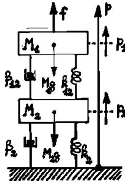
Determinare le equazioni del moto delle due masse, assumendo i seguenti valori numerici dei parametri:  $M_1 = 2 \text{ kg}$ ,  $M_2 = 5 \text{ kg}$ ,  $k_2 = 30 \text{ N/m}$ ,  $k_{12} = 10 \text{ N/m}$ ,  $\beta_2 = 20 \text{ Ns/m}$ ,  $\beta_{12} = 10 \text{ Ns/m}$ ,  $g = 9.81 \text{ m/s}^2$ .
