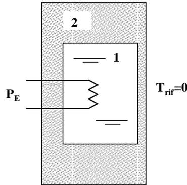
*Soluzione:*  $A = \frac{1}{RC_0} \begin{bmatrix} -1 & 1 \\ 1 & -2 \end{bmatrix}$ ,  $B = \frac{1}{C_0} \begin{bmatrix} 0.5 \\ 0 \end{bmatrix}$ ,  $C = [0 \quad 1]$
