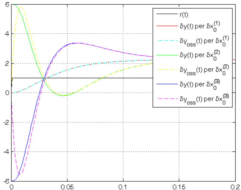
Stato  $\delta x_1(t)$  del sistema controllato mediante regolatore e sua stima  $\delta x_{\text{oss},1}(t)$  al variare di  $\delta x_C$
