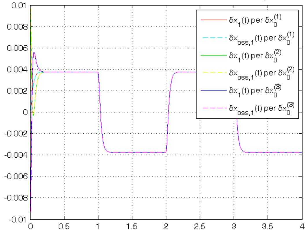
Stato  $\delta x_1(t)$  del sistema controllato mediante regolatore e sua stima  $\delta x_{\text{oss},1}(t)$  al variare di  $\delta x_C$
