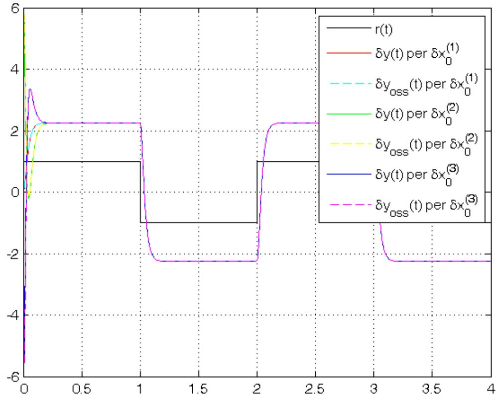
Risposta  $\delta y(t)$  del sistema controllato mediante regolatore e sua stima  $\delta y_{\text{oss}}(t)$  al variare di  $\delta x_1$
