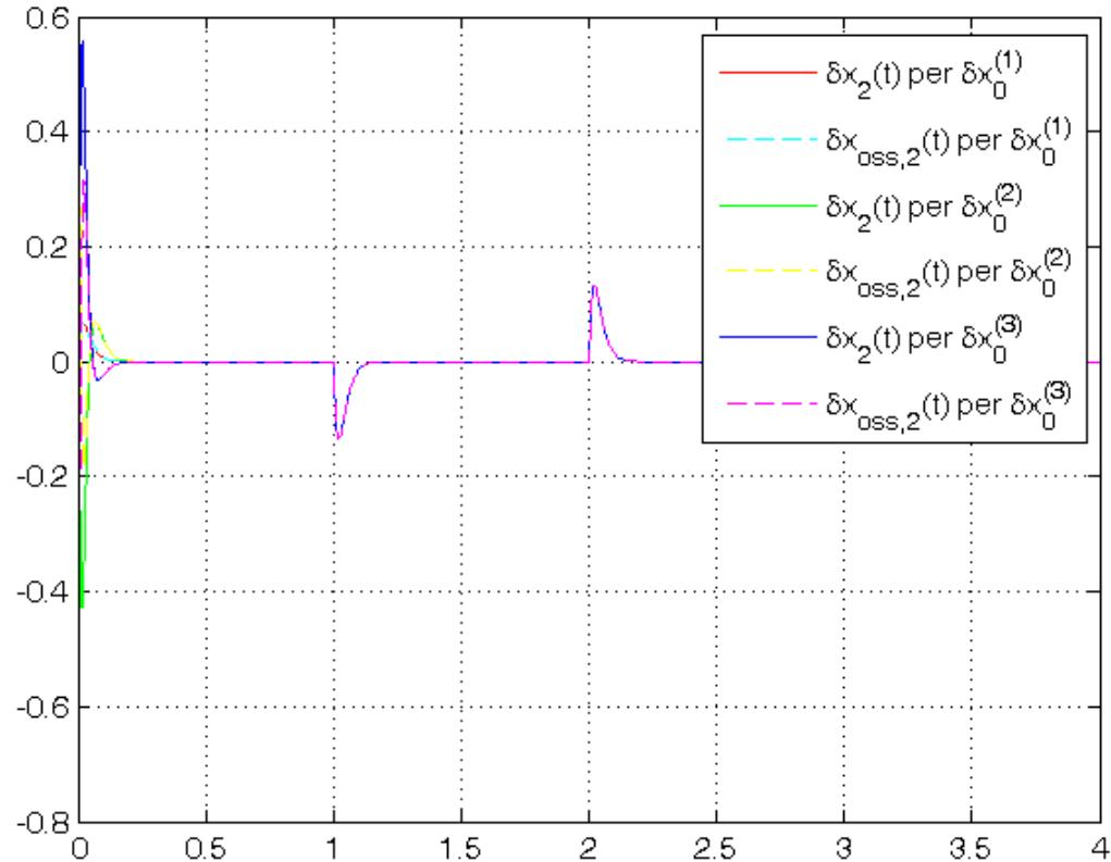
Stato  $\delta x_2(t)$  del sistema controllato mediante regolatore e sua stima  $\delta x_{\text{oss},2}(t)$  al variare di  $\delta x_C$
