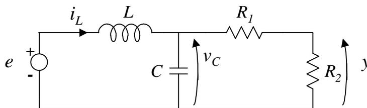
Determinare le matrici  $A$ ,  $B$ ,  $C$  e  $D$  della rappresentazione in variabili di stato del sistema  $\dot{x} = Ax + Bu$ ,  $y = Cx + Du$ , scegliendo come variabile di stato  $x = [i_L, v_C]^T$  e come variabile di ingresso  $u = e$ .
