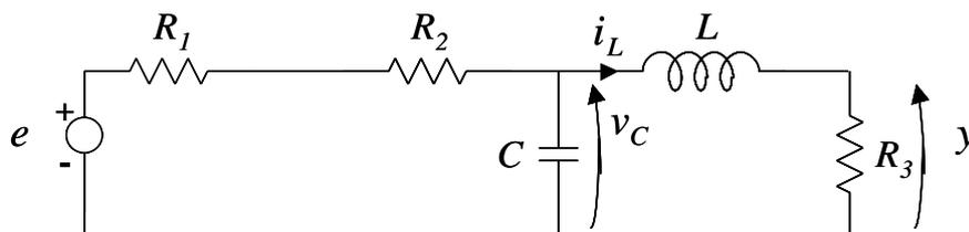
Calcolare la funzione di trasferimento  $G(s)$  fra l'ingresso  $E(s) = \mathcal{L}\{e(t)\}$  e l'uscita  $Y(s) = \mathcal{L}\{y(t)\}$ .
