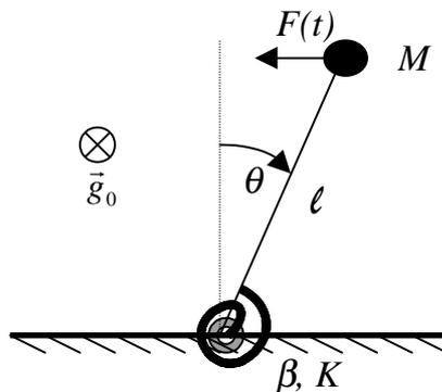
Determinare il modello matematico in variabili di stato di tale sistema dinamico, scegliendo come variabile di stato  $x(t) = [\theta(t), \dot{\theta}(t)]^T$  e considerando i seguenti valori numerici dei parametri:  $M = 0.2$  kg,  $\ell = 0.5$  m,  $\beta = 0.1$  Nms/rad,  $K = 0.3$  Nm/rad.
