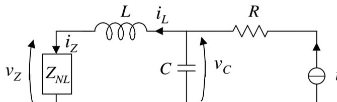
Scrivere le equazioni di stato del sistema, scegliendo come variabile di stato  $x = [i_L, v_C]^T$  e come variabile di ingresso  $u = i$ .
