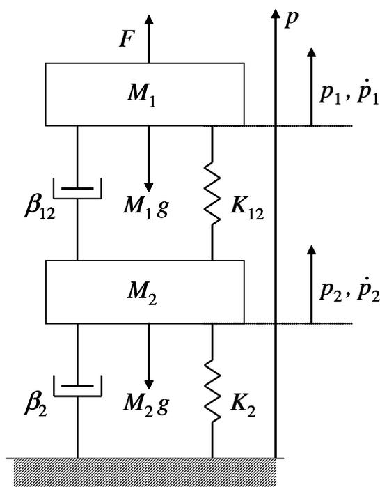
Determinare le equazioni del moto delle due masse, assumendo i seguenti valori numerici dei parametri:  $M_1 = 2 \text{ kg}$ ,  $M_2 = 5 \text{ kg}$ ,  $K_2 = 30 \text{ N/m}$ ,  $K_{12} = 10 \text{ N/m}$ ,  $\beta_2 = 20 \text{ Ns/m}$ ,  $\beta_{12} = 10 \text{ Ns/m}$ ,  $g = 9.81 \text{ m/s}^2$ .
