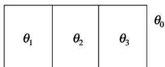
Determinare la matrice  $A$  dell'equazione di stato del sistema  $\dot{x} = Ax + Bu$ , scegliendo come variabile di stato  $x = [\theta_1 \ \theta_2 \ \theta_3]^T$  e come ingresso  $u = \theta_0$ .
