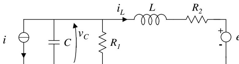
Determinare le matrici  $A$  e  $B$  dell'equazione di stato del sistema  $\dot{x} = Ax + Bu$ , scegliendo come variabile di stato  $x = [v_C, i_L]^T$  e come variabile di ingresso  $u = [i, e]^T$ .
