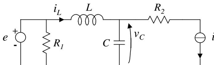
Determinare le matrici  $A$  e  $B$  dell'equazione di stato del sistema  $\dot{x} = Ax + Bu$ , scegliendo come variabile di stato  $x = [i_L, v_C]^T$  e come variabile di ingresso  $u = [e, i]^T$ .
