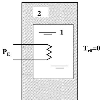
Scrivere le equazioni di bilancio termico che descrivono il sistema dato, assumendo che le capacità dei due corpi siano pari a  $C_1 = C_2 = C$  e le conduttanze termiche fra i due corpi e fra il corpo **2** e l'ambiente siano  $K_{12} = K_{20} = 1/(0.5R)$ , ove  $0.5R$  è la resistenza termica fra i vari elementi.
