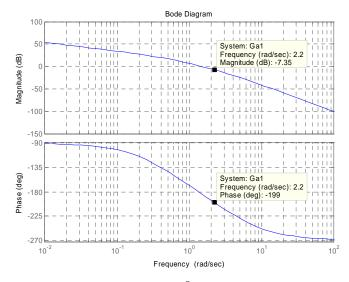
Si rileva quindi la necessità di recuperare circa  $65^{\circ}$  in corrispondenza di  $\omega_{c,des}$ , utilizzando due reti anticipatrici e facendo in modo che l'aumento complessivo di modulo non sia superiore a 7.35 dB. Se l'aumento di modulo dovesse risultare significativamente minore di tale quantità, sarà sufficiente incrementare opportunamente il valore assoluto di  $K_c$ .
