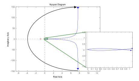
Si assume quindi  $K_c = -1.5$ ; se necessario, il modulo di tale parametro potrà essere incrementato, ma non ridotto.
