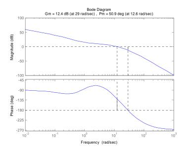
Avendo soddisfatto i requisiti operativi imposti, si determina la funzione di trasferimento W(s) del sistema ad anello chiuso (con il comando feedback) per la verifica delle specifiche imposte.
