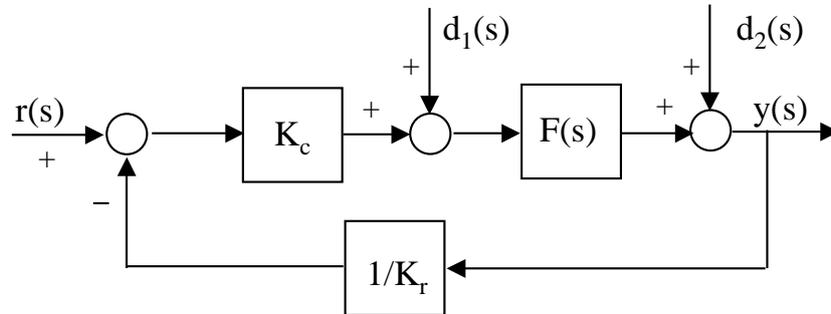
Sia  $G_a(s) = \frac{K_c}{K_r} F(s)$  la funzione di trasferimento d'anello del sistema retroazionato, ove  $K_r = 0.5$ .
