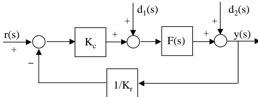
Sia  $G_a(s) = \frac{K_c}{K_r} F(s)$  la funzione di trasferimento d'anello del sistema retroazionato, ove  $K_r = 2$ .
