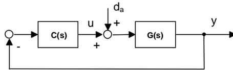
Per quanto riguarda il disturbo di ingresso  $d_a$  si possono sviluppare calcoli analoghi che portano a concludere che il contributo sull'uscita in regime permanente dipende dal "tipo"  $g_c$  **della funzione di trasferimento di ciò che si trova a monte del disturbo**  $d_a$
